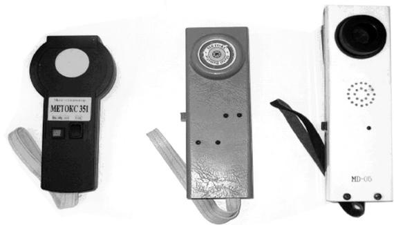
Рис. 2. Модели металлоиндикаторов: Метокс-351, Метокс-311, МД-0,5
