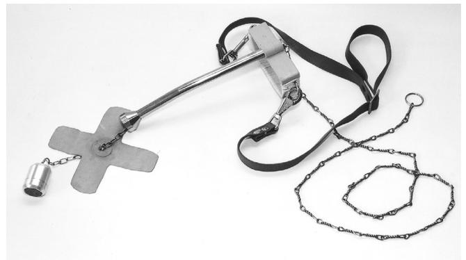
Рис. 3. Магнитный зонд А.В. Коробова (ЗМК-21) в сборке
